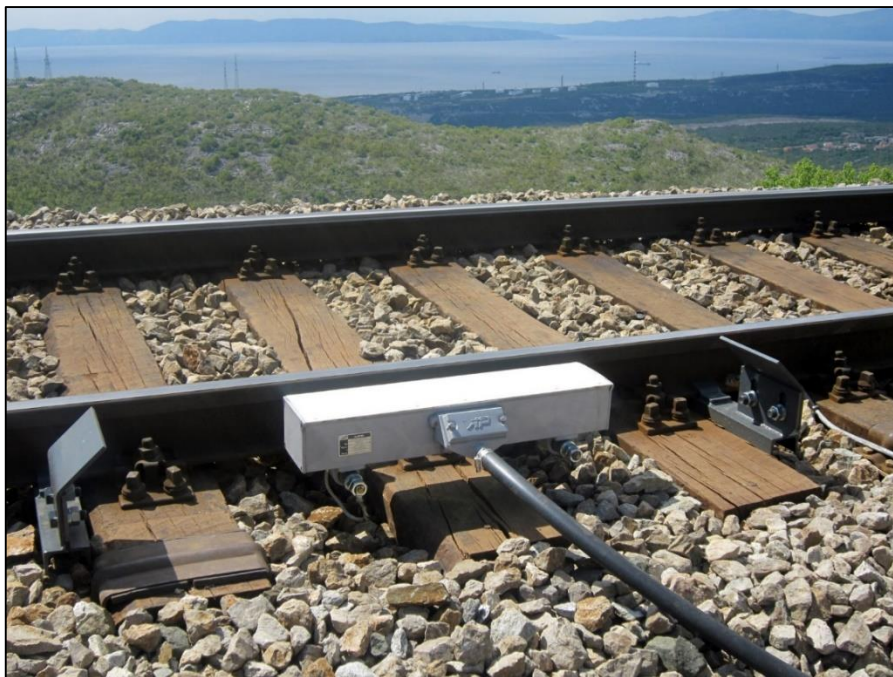
Slika 17. INDUSI pružna baliza [autor]
