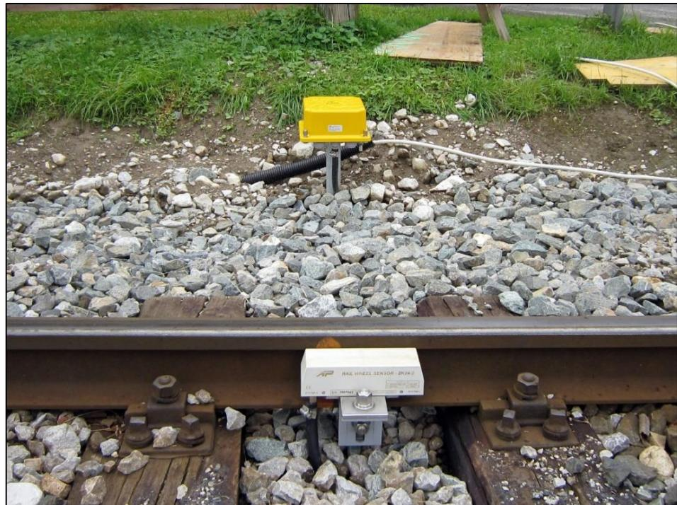
Slika 4. Moderni senzor željezničkog kotača [27]
