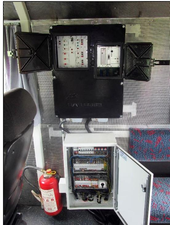
Slika 24. Centralna jedinica u vozilu
