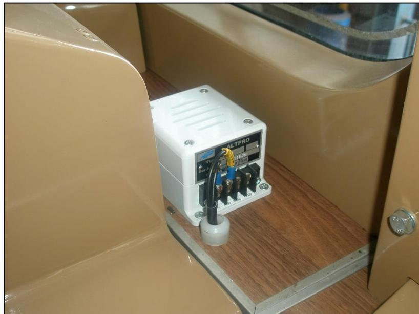
Slika 12. Trotontski signalizator sustava budnosti UDB [autor]
