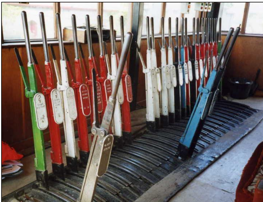
Slika 2. Ručice mehaničkih signala [17]
