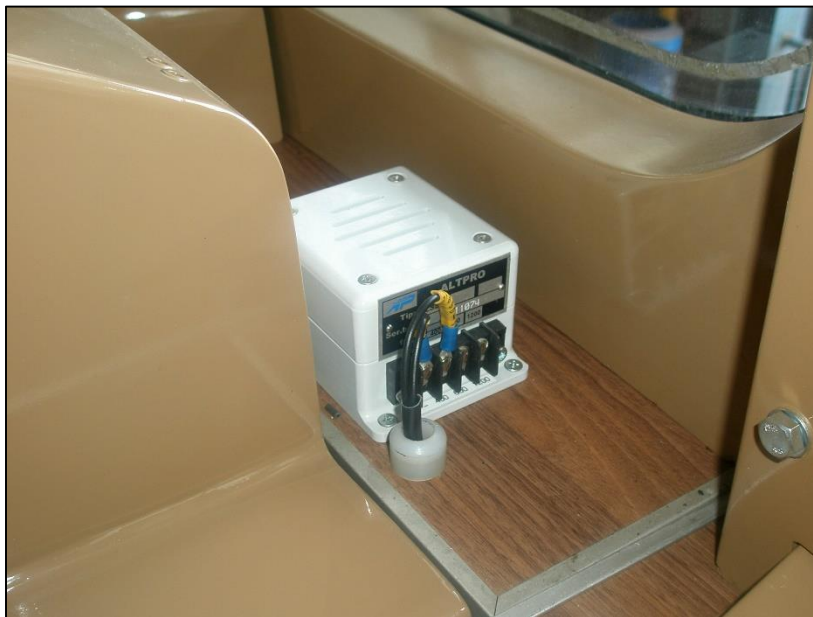
Slika 12. Trotonski signalizator sustava budnosti UDB [autor]
