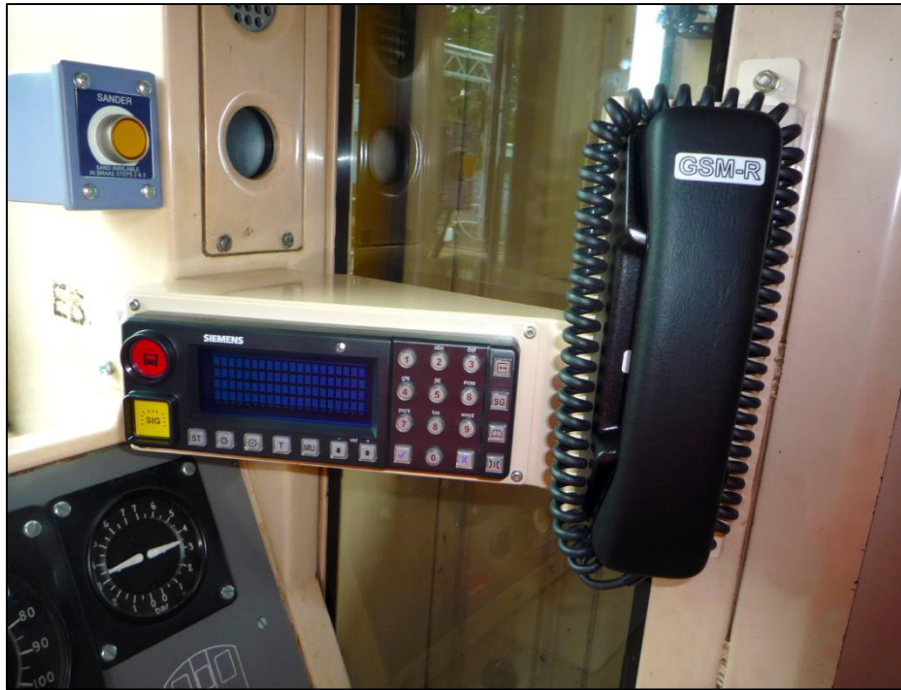
Slika 15. GSM-R stanica u lokomotivi [20]
