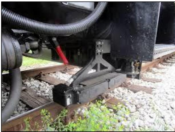
Slika 23. Ugrađena lokomotivska baliza na vozilu [autor]
