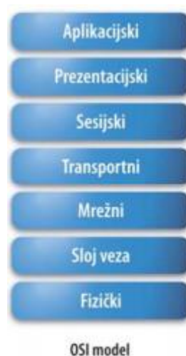
Slika 4: Slojevi OSI modela., [15]
