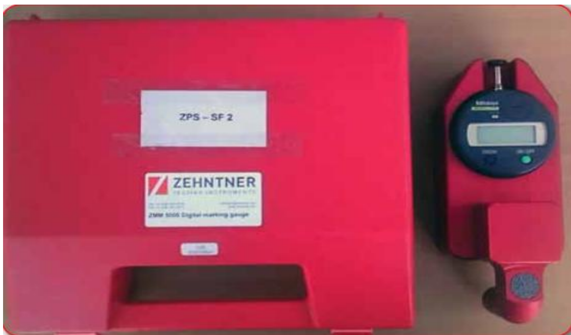
Slika 28: Uređaj za mjerenje debljine suhog filma boje
