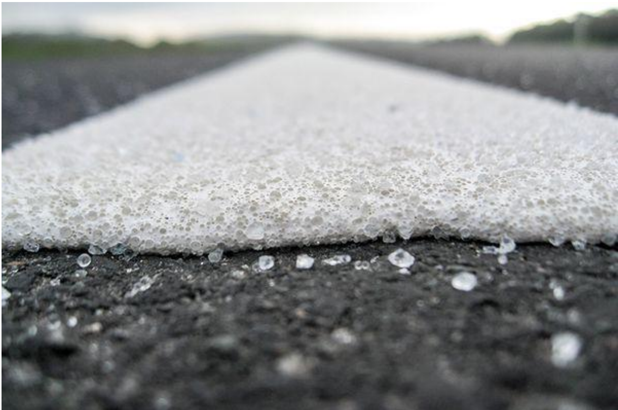
Slika 17: ViaTherm – termoplastični materijal za izradu oznaka na kolniku
