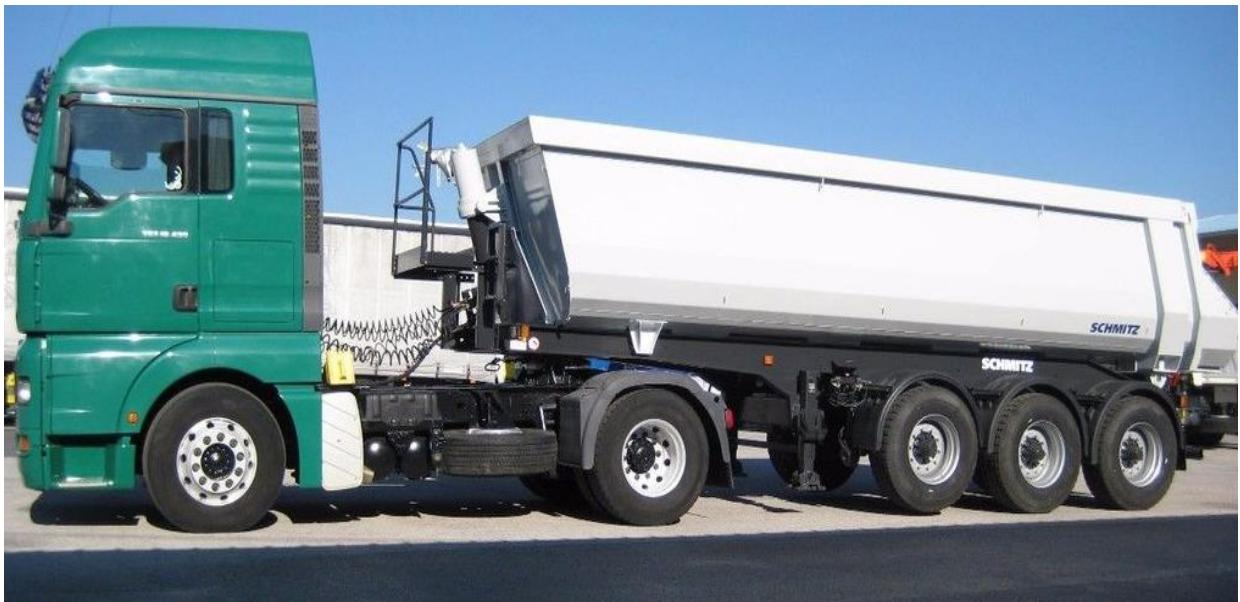
Slika 2: Sklop vozila tegljač i poluprikolica
