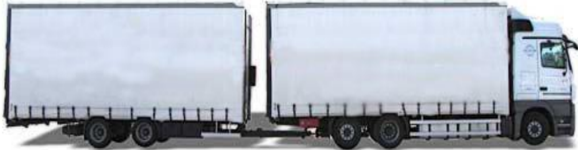
Slika 1: Sklop vučnog motornog vozila i prikolice
