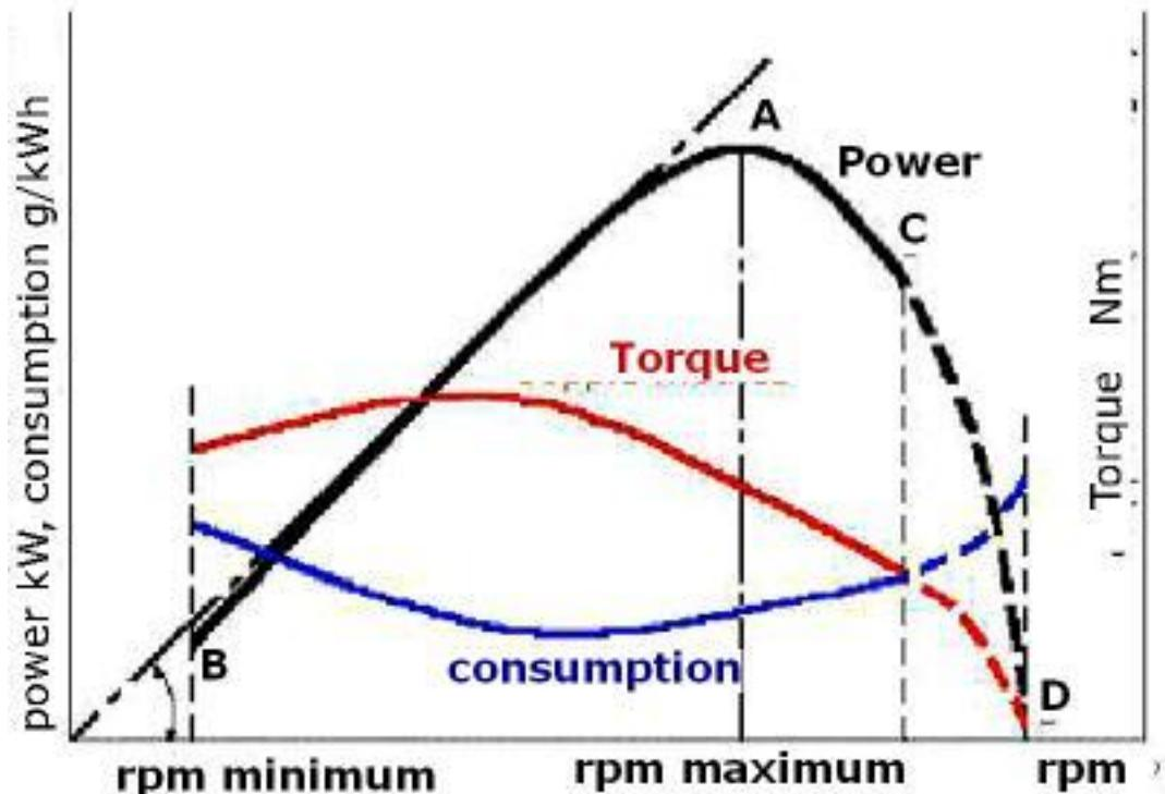
Slika 15: Prikaz vanjske brzinske značajke
