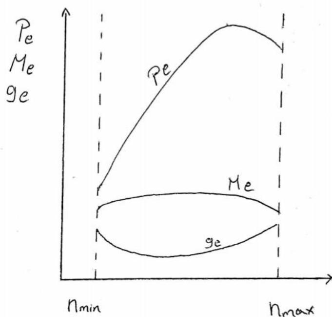
Slika 17: Vanjska brzinska značajka Otto motora
