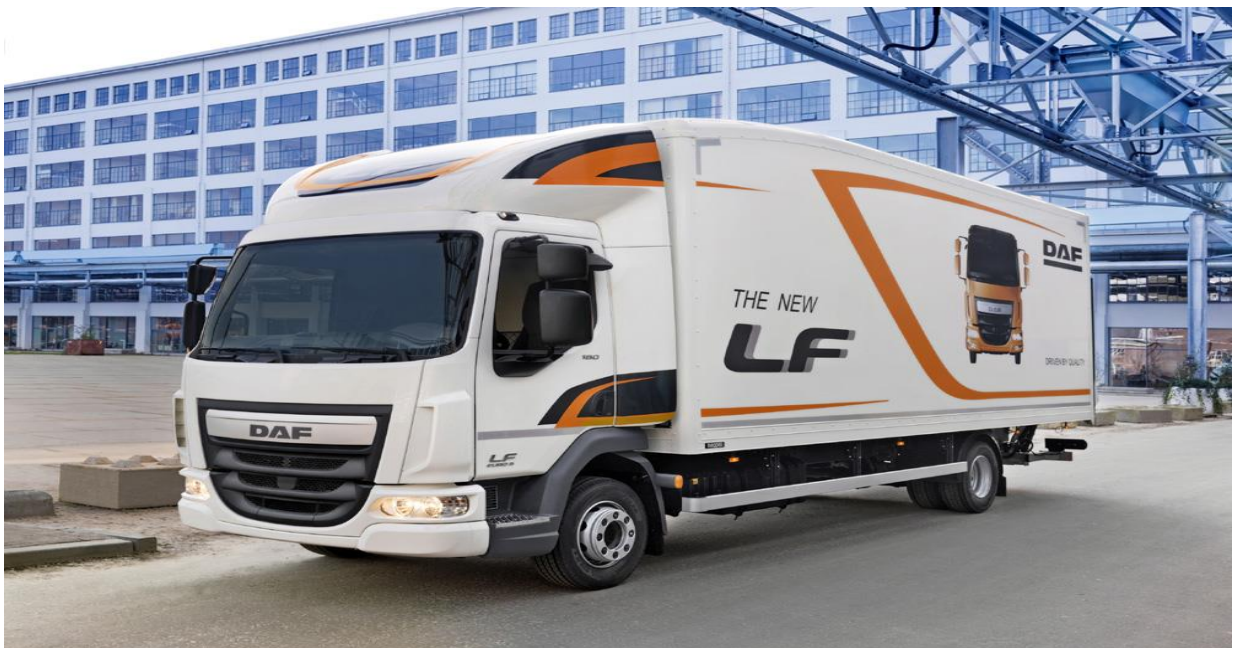
Slika 7: Prikaz vozila koje spada u kategoriju N2
