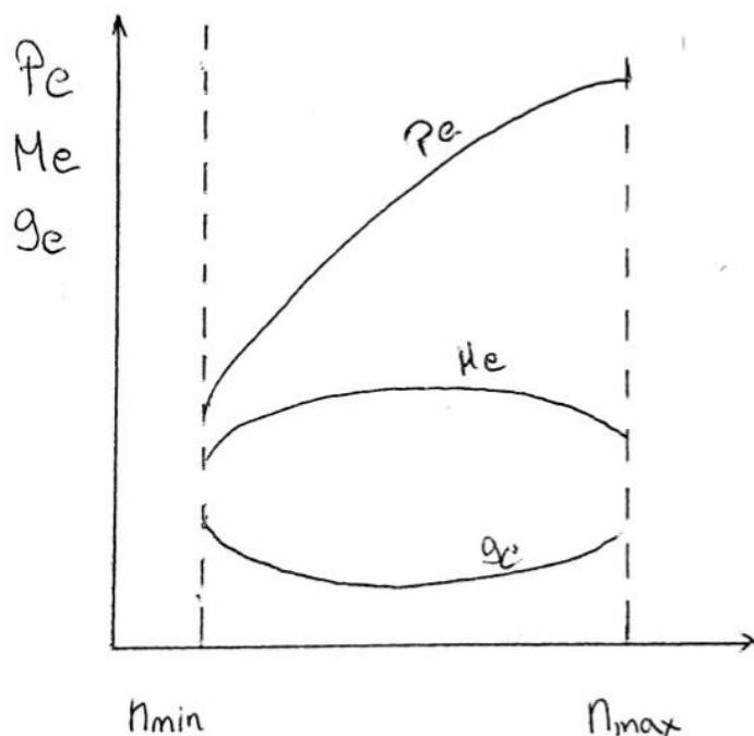
Slika 16: Vanjska brzinska značajka Diesel motora
