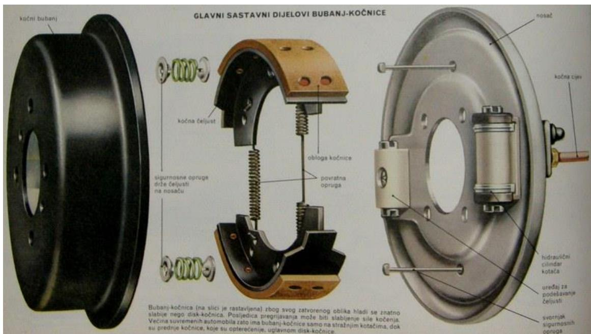
Slika 16. Dijelovi bubanj kočnice
