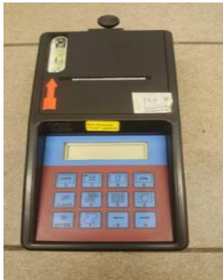
Slika 30. Mjerač usporenja (decelerometar) MAHA VZM 100
