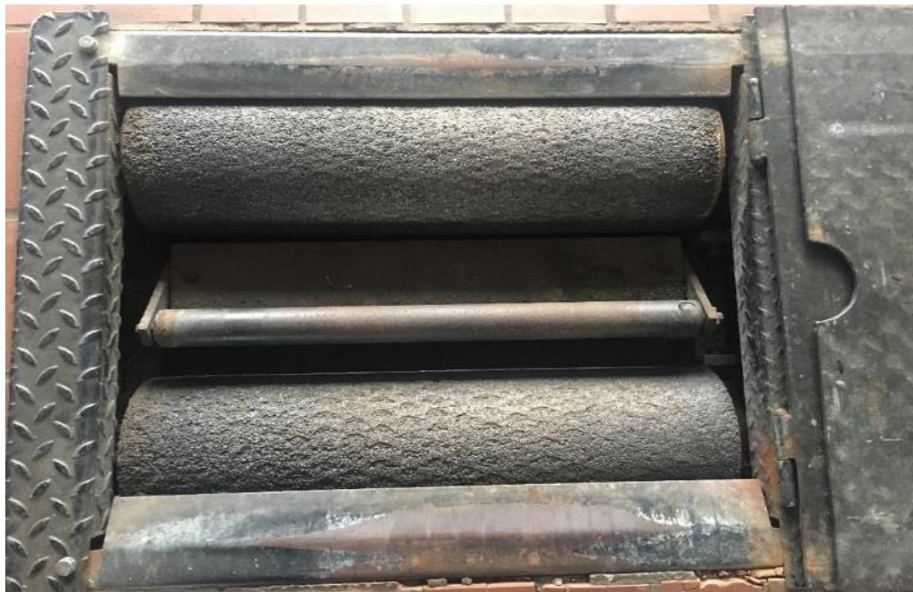
Slika 22. Valjci za ispitivanje kočnica
