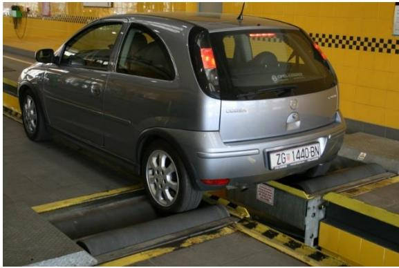
Slika 26. Vozila na valjcima za ispitivanje
