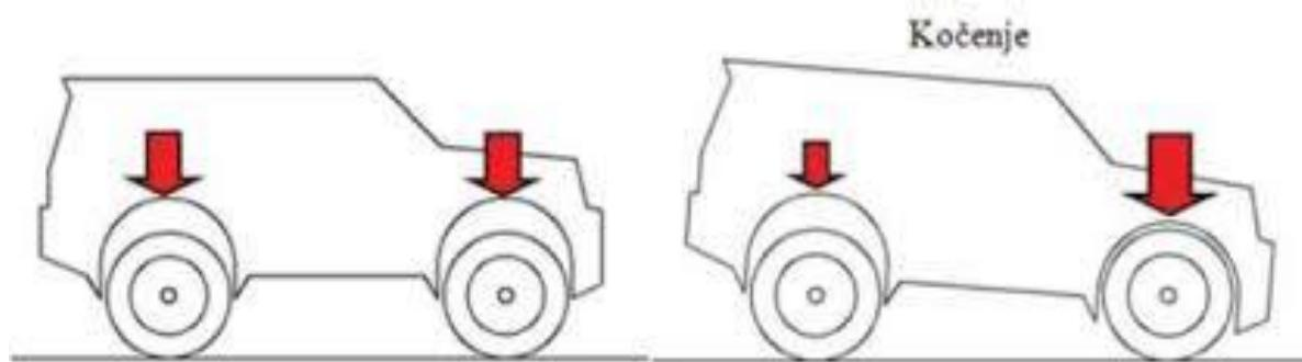
Slika 5. Preraspodjela opterećenja na osovine pri kočenju vozila
