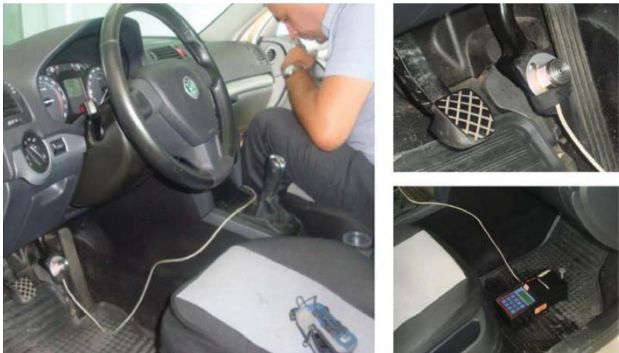
Slika 31. Postavljanje dinamometra i decelerometra u vozilo
