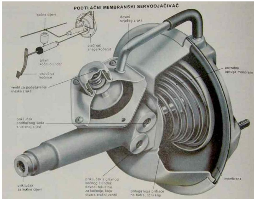
Slika 15. Vakuumski servocilindar
