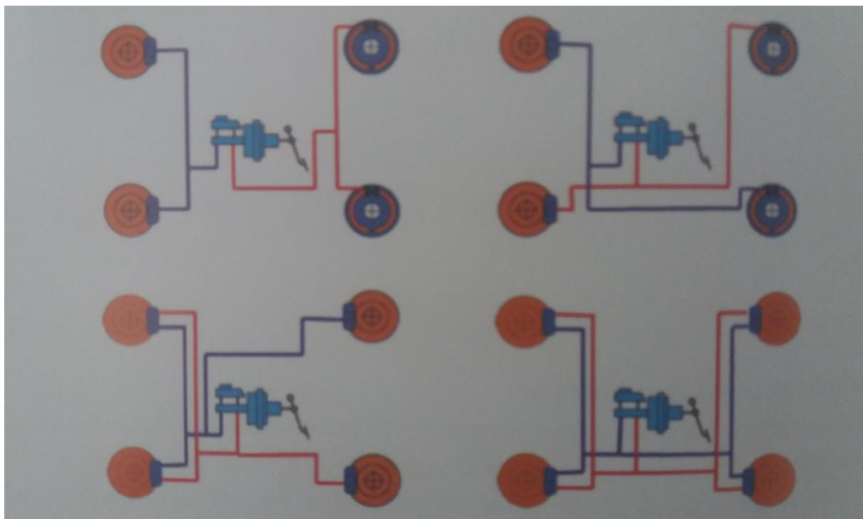
Slika 13. Dvokružne hidraulične kočnice
