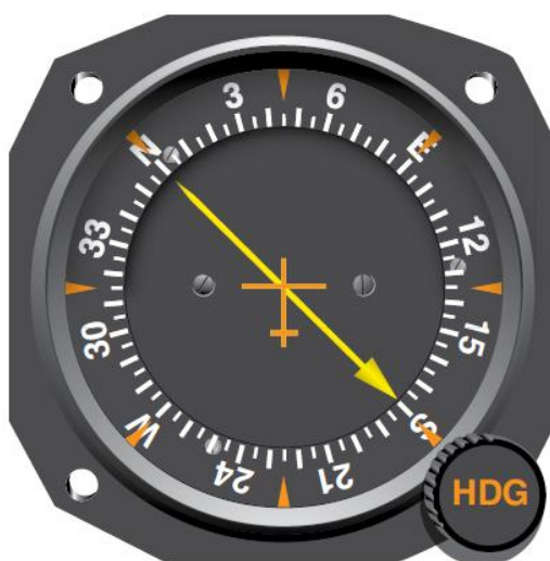
Slika 10. Pokazivač smjera NDB-a u zrakoplovu
