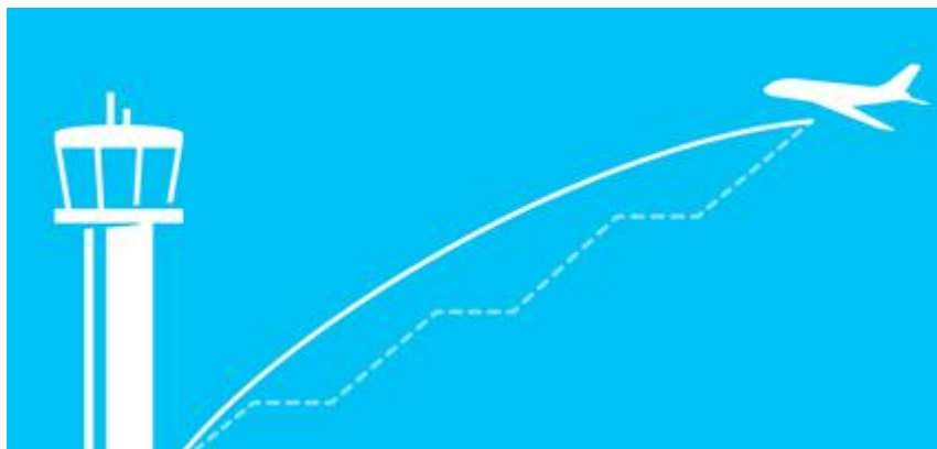
Slika 20. Operacija kontinuiranog spuštanja
