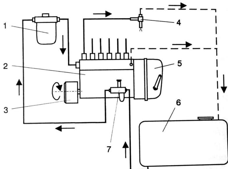
Slika 7. Shema sustava za napajanje dizel motora [13]
