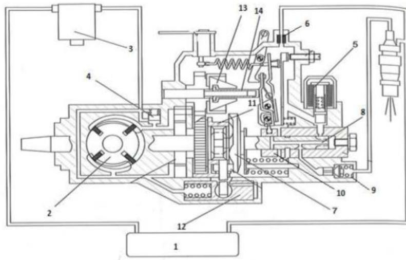
Slika 16. Visokotlačna aksijalna razvodna pumpa [1]
