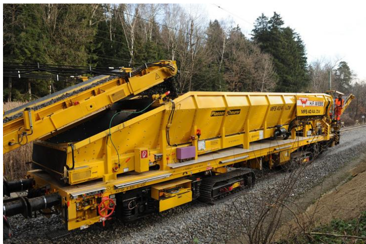
Slika 24. Vagon za prijevoz otpadnog materijala [6]
