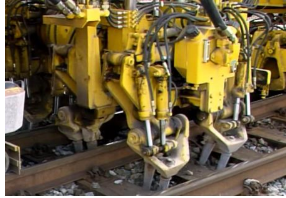
Slika 7. Podbijački agregat podbijačice [6]
