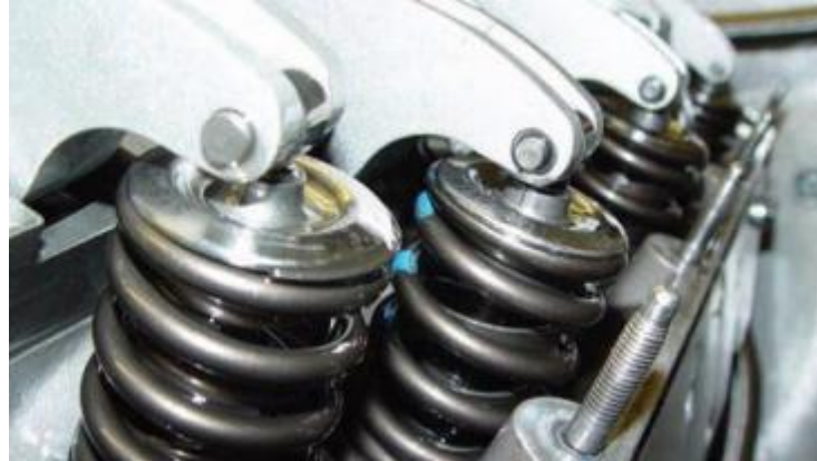
Slika 15. Opruge na ventilima, [3].
