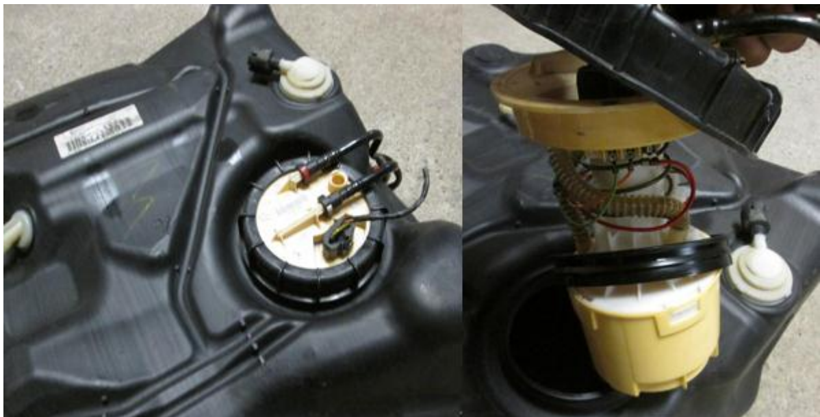
Slika 20. Pumpa za gorivo uronjena u spremnik goriva, [21].
