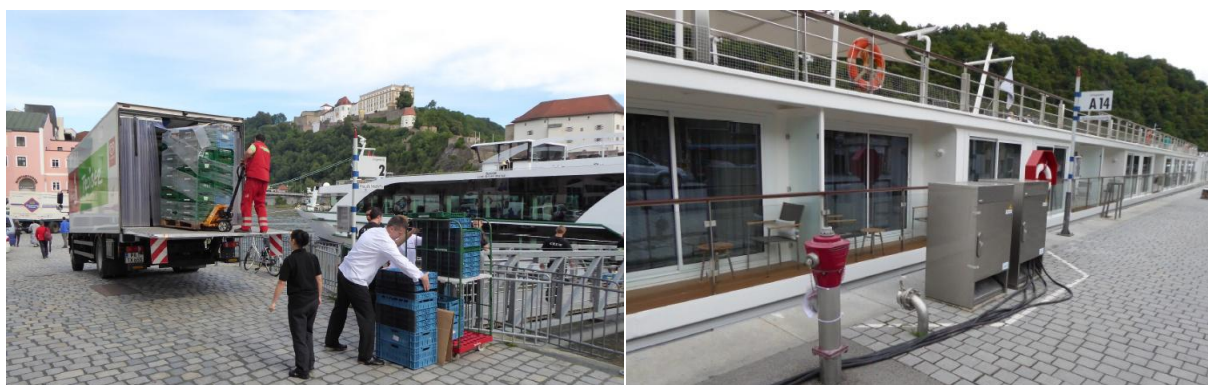
Slika 20. i 21. Opskrba broda namirnicama (20.) i priključci za vodu, struju i odvod (21.)
