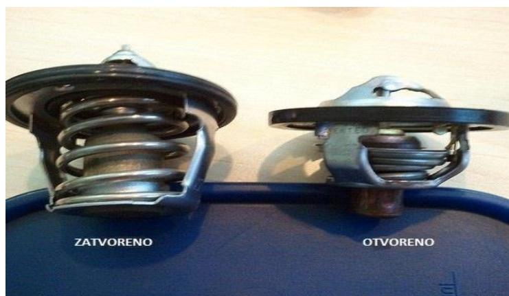
**Slika 22.** Prikaz zatvorenog (lijevo) i otvorenog (desno) termostata
