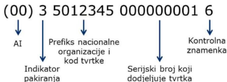
Slika 3. Dijelovi SSCC barkoda
