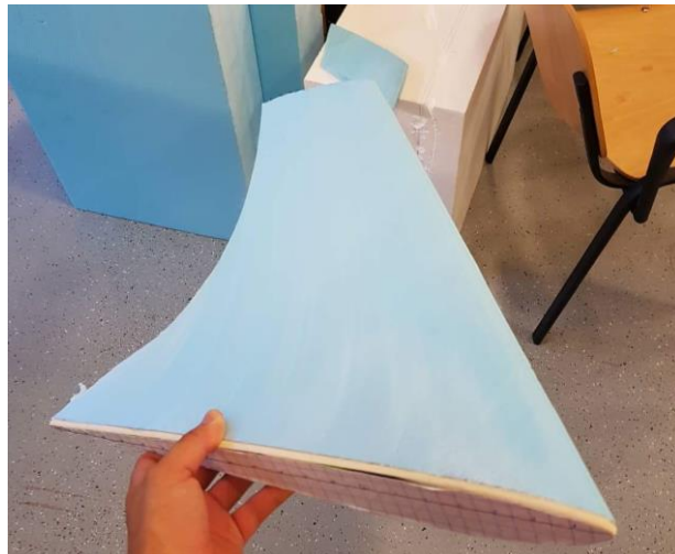
Slika 20 Neuspjeli pokušaj rezanja strukture krila
