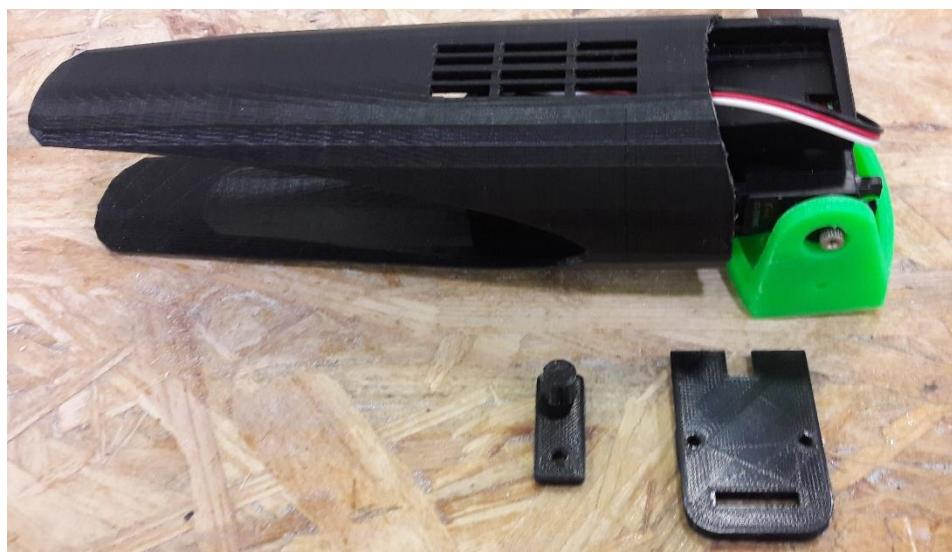
Slika 25 VTOL nosač i njegovi dijelovi
