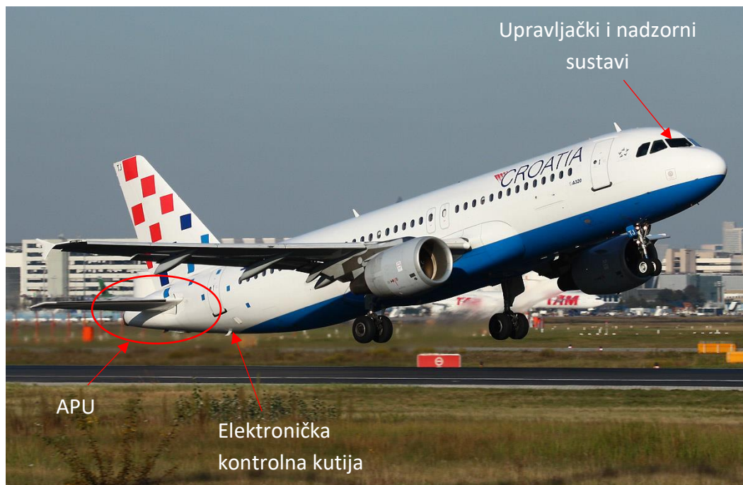
Slika 3. Glavne komponente APS 3200
