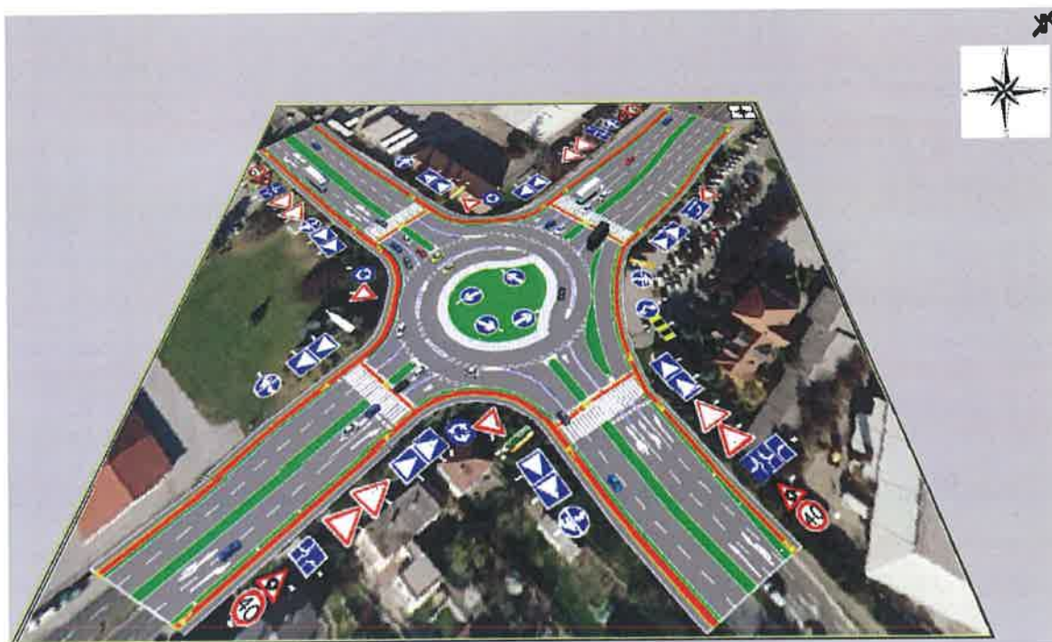
Slika 68. Simulacijski model varijante 3 – turbo kružno raskrižje
