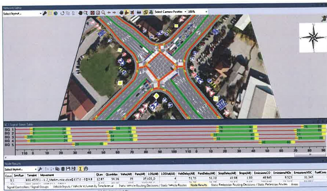
Slika 63. Simulacijski model varijante 1 – uvođenje adaptivnog upravljanja prometom programom PTV Epics
