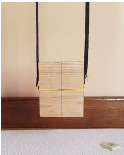
Slika 10 - Postavka za određivanje momenata oko x osi
