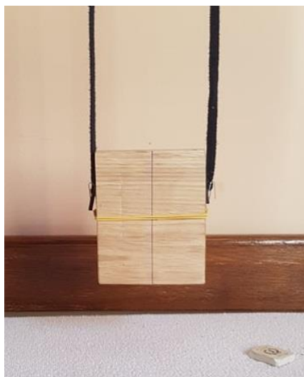
Slika 10 - Postavka za određivanje momenata oko x osi
