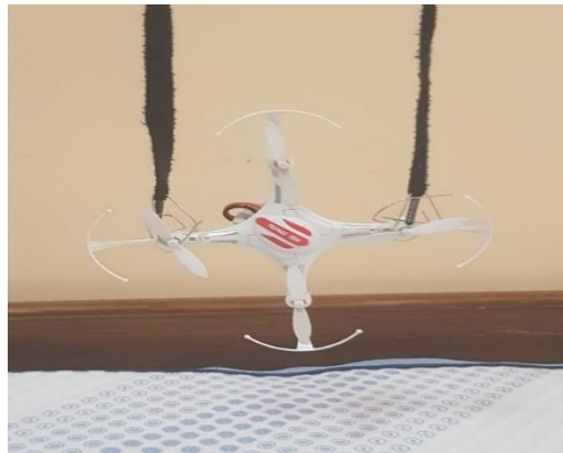
Slika 16 - Postavka za određivanje momenata oko y osi
