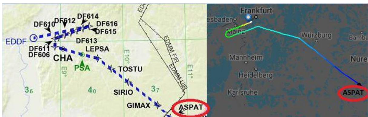
Slika 19. Usporedba prilaza na aerodrom EDDF [9]
