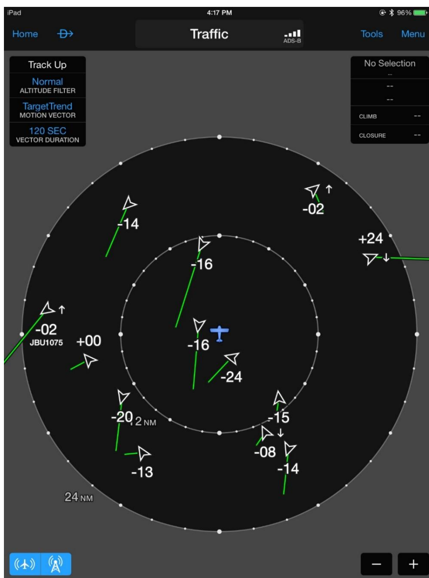
Slika 2. Mobilna aplikacija Garmin;-prikaz prometa korištenjem ADS sustava, [11]
