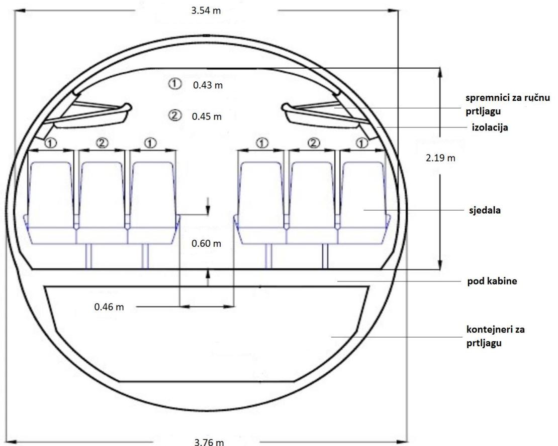
**Slika 6.** Poprečni presjek putničke kabine B737 [9]
