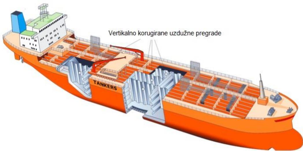
Slika 15. Vertikalno korugirane uzdužne pregrade na tankeru
