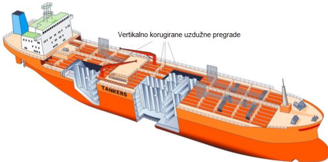
Slika 15. Vertikalno korugirane uzdužne pregrade na tankeru Izvor: [16]
