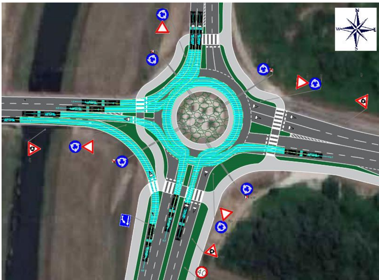
Slika 33. Prikaz provjere trajektorija predloženog idejnog rješenja
