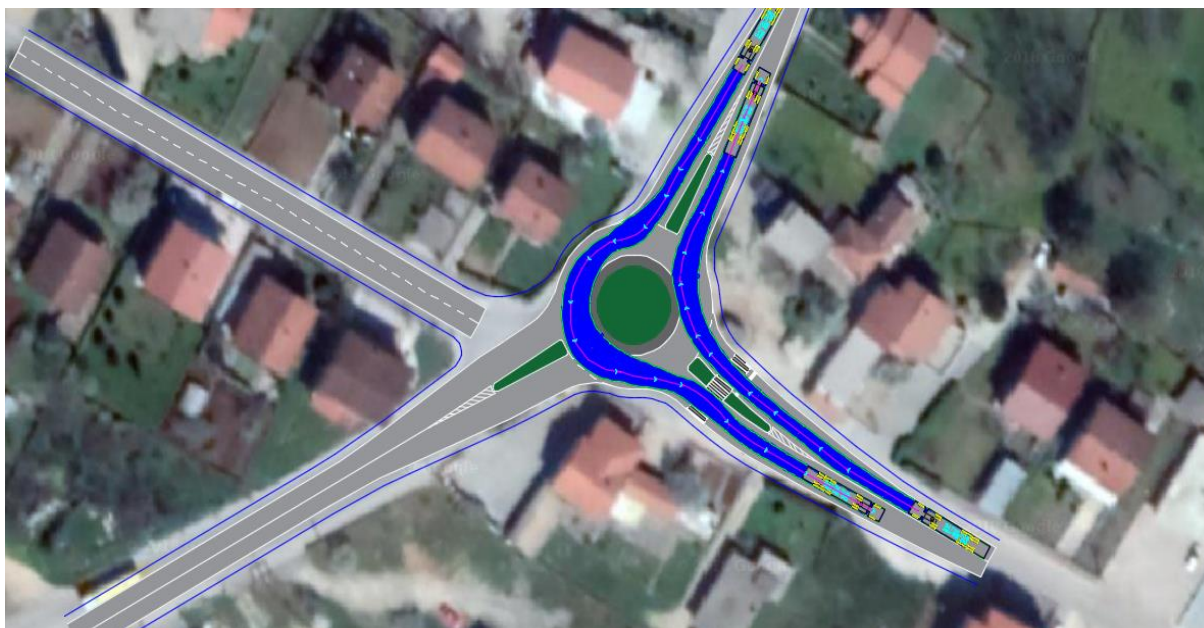
Slika 28. Trajektorija provoženja mjerodavnog vozila na raskrižju 1
