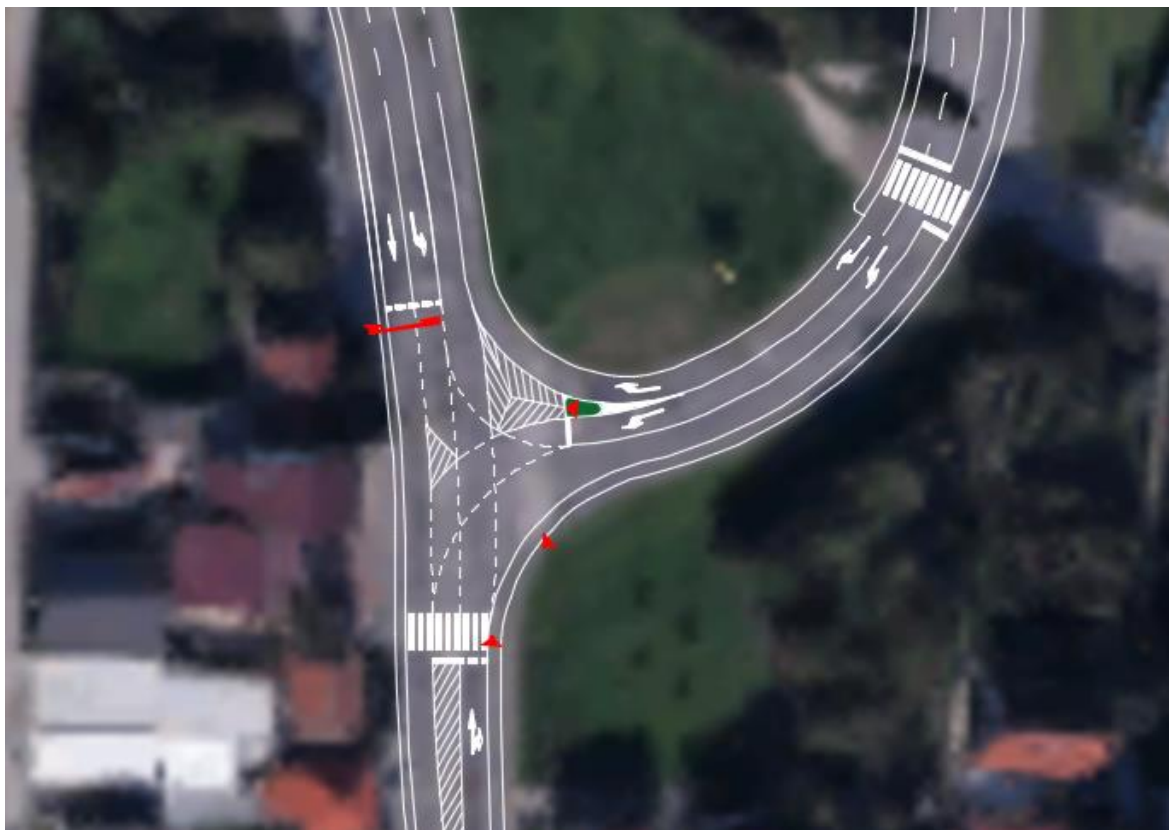
Slika 35 Idejno rješenje raskrižja Oranice – Kožinčev put
