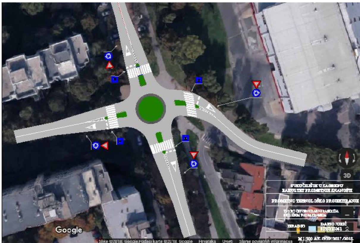
Slika 5.8. Prijedlog idejnog rješenja raskrižje 3
