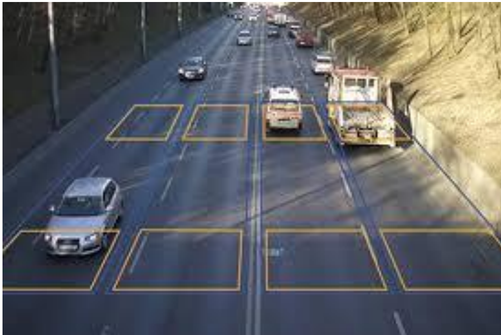
Slika 5.1. Primjer „virtualne petlje“ video detektora
