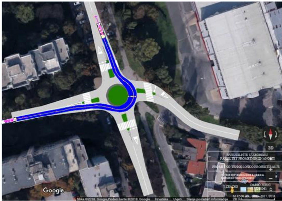
Slika 5.9. Provjera trajektorija iz zapadnog u sjeverni privoz
