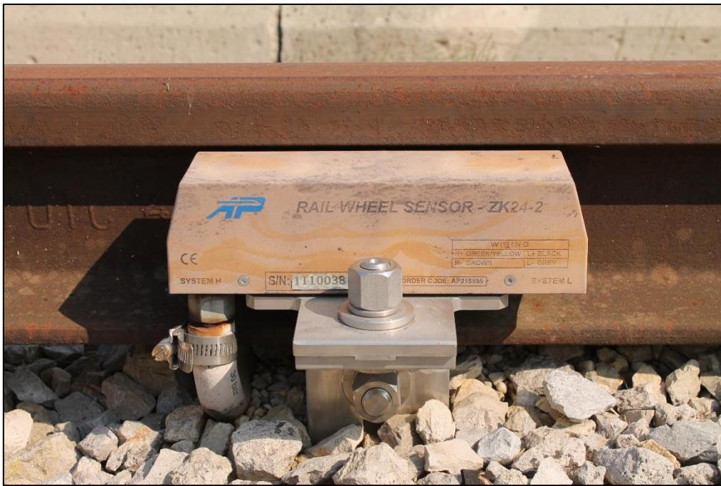
Slika 25. Senzor željezničkog kotača ZK24-2
