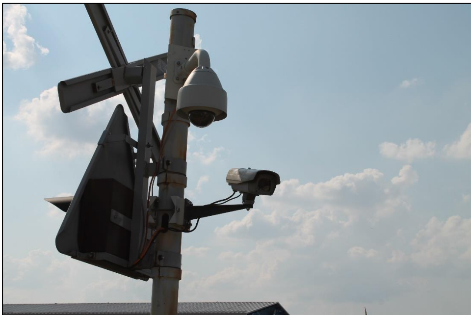
Slika 31. Kamere za detekciju objekata na poligonu tvrtke Altpro d.o.o.
