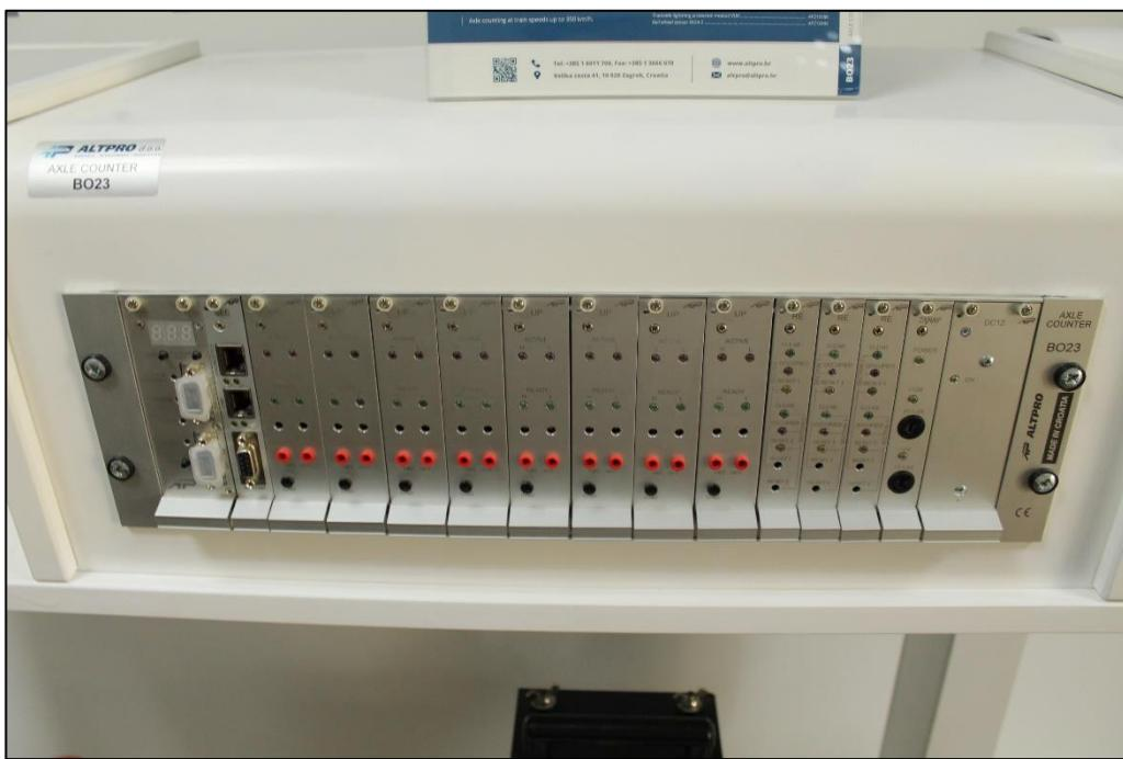
Slika 28. Brojač osovina BO-23 tvrtke Altpro d.o.o.
