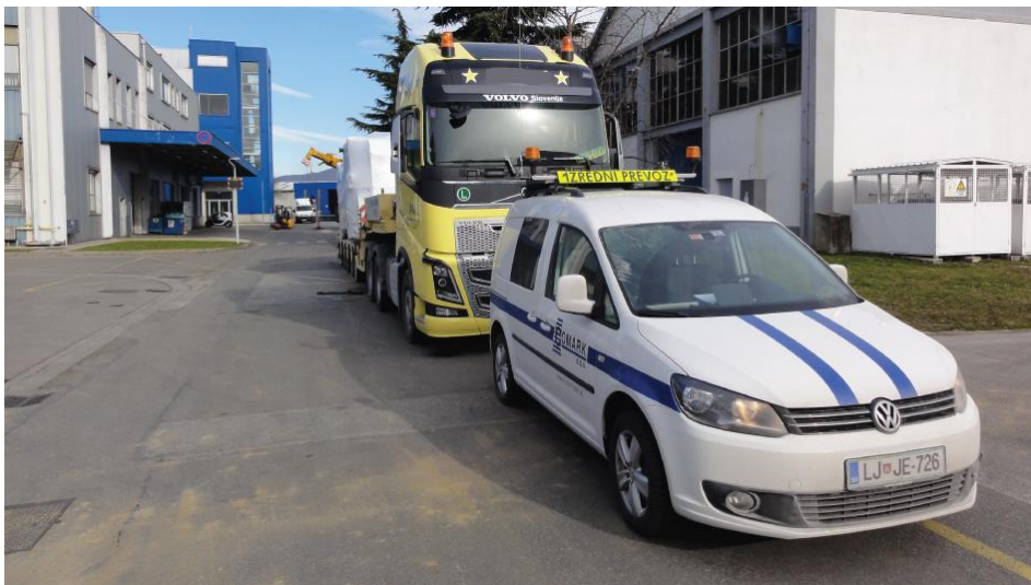
Slika 4 Prikaz pratećeg vozila s rotirajućim žutim svjetlima kod transporta specijalnog tereta
