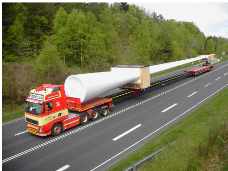
Slika 7 Prikaz transporta elise vjetroturbine duljine 62 metra cestovnom prometnicom
