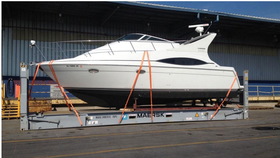
Slika 3 Primjer postavljanja jahte na flat rack kontejner
