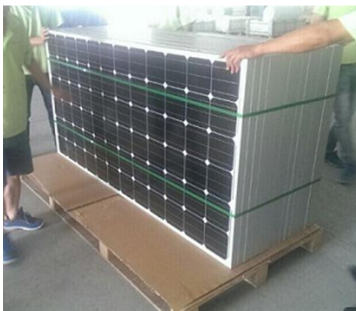
Slika 10. Način slaganja solarnih panela na paletu
