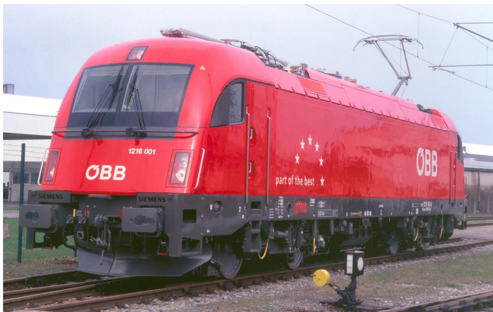
Slika 11 Lokomotiva ES64U4-A serije Rh 1216 Austrijskih željeznica (ÖBB)
