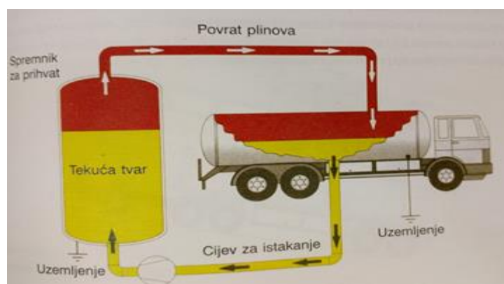
Slika 11: Pražnjenje cisterne zatvorenim EKO sustavom
