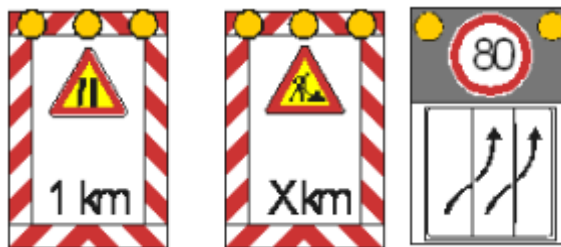
Slika 21.: Pokretna signalna ploča s promjenjivim sadržajem [1]
