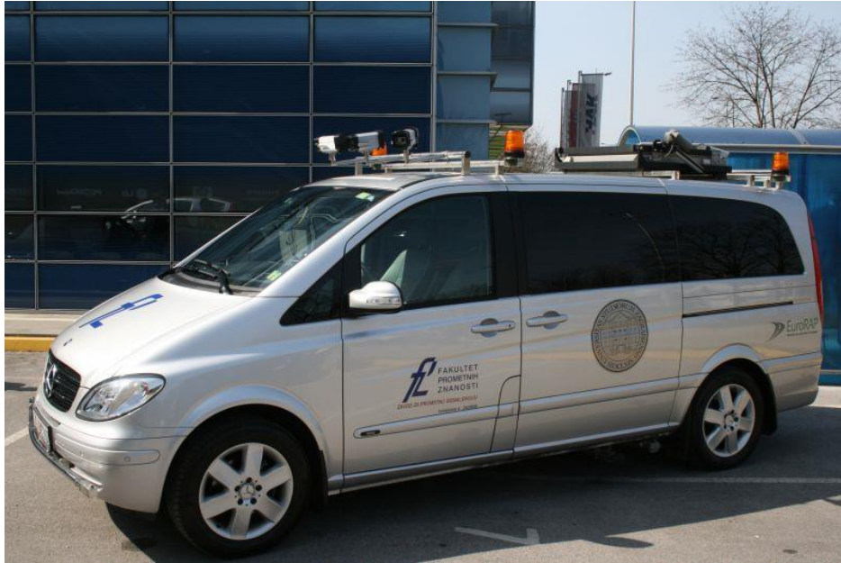
Slika 4. Vozilo za ispitivanje rizika prometnica
