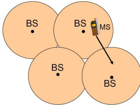
**Slika 3.** Prikaz ćeljske strukture GSM sustava
