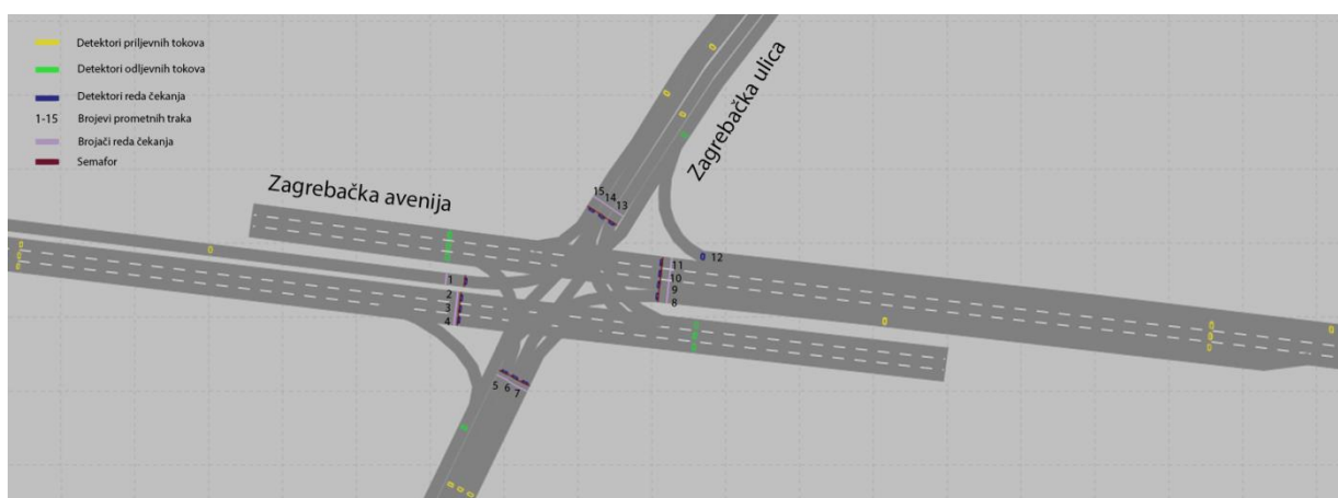
Slika 9. Prikaz označavanja detektora unutar modela semaforiziranog raskrižja
