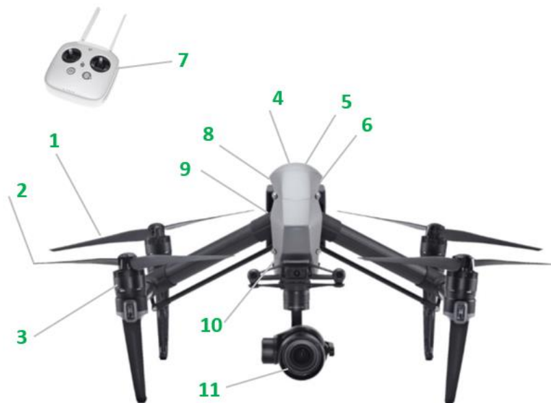
Slika 3. Glavne komponente dronova
