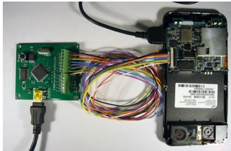
Slika 11. JTAG ekstrakcija podataka s mobilnog uređaja, [34]
