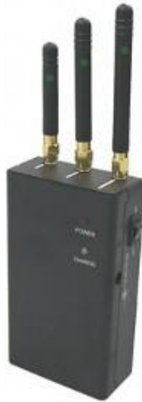
Slika 7. Blokator signala mobilnog uređaja, [23]
