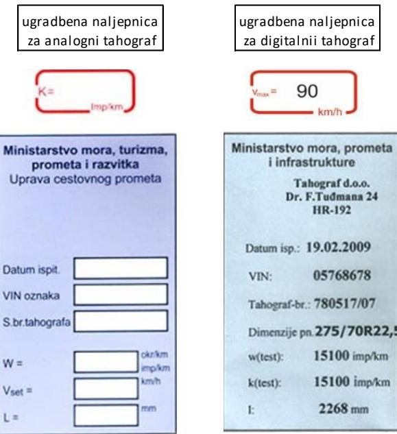
Slika 24.— Ugradbena naljepnica za analogni i digitalni tahograf
