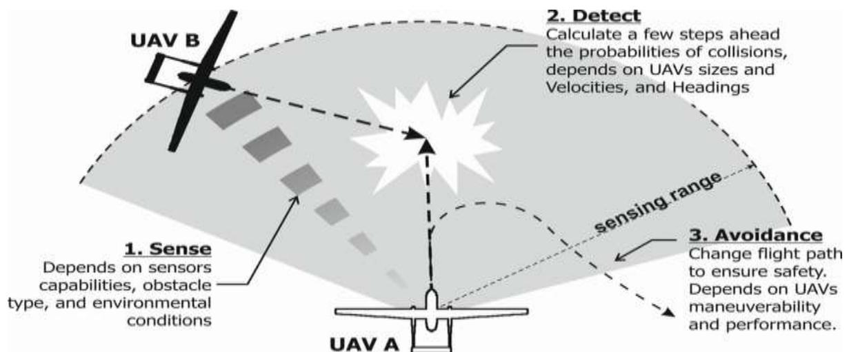
**Slika 5.** Otkrivanje i izbjegavanje prepreka bespilotnih zrakoplova
