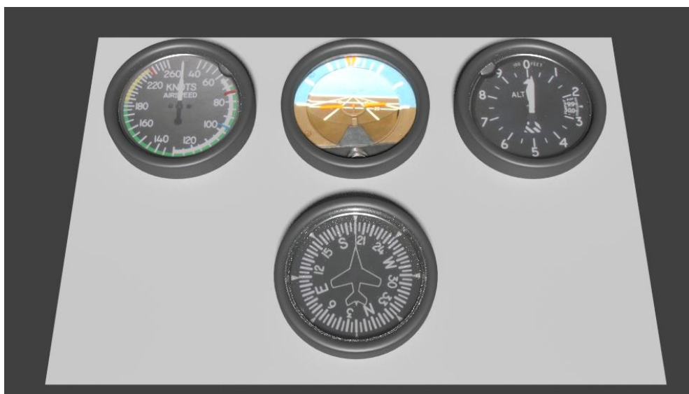
Slika 3.11. T-model rasporeda prikaznika;
