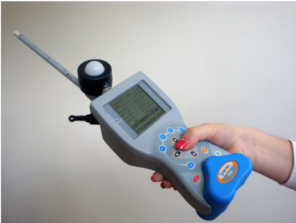
Slika 4.15. Kalibrirani prijenosni digitalni višenamjenski ručni instrument Metrel Poly MI 6401 EU za mjerenje parametara okoliša. Izvor: preuzeto od Sumpor, D. 2013. [13]
