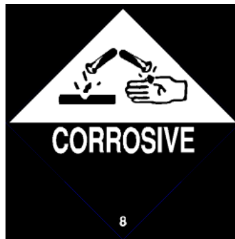
Slika 5. RCM (Corrosive) - Oznaka korozivnih materijala
