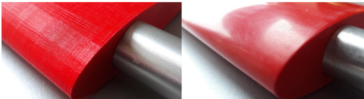
Slika 4.36. Prikaz detalja aeroprofila prije brušenja (lijevo) i nakon brušenja (desno)
