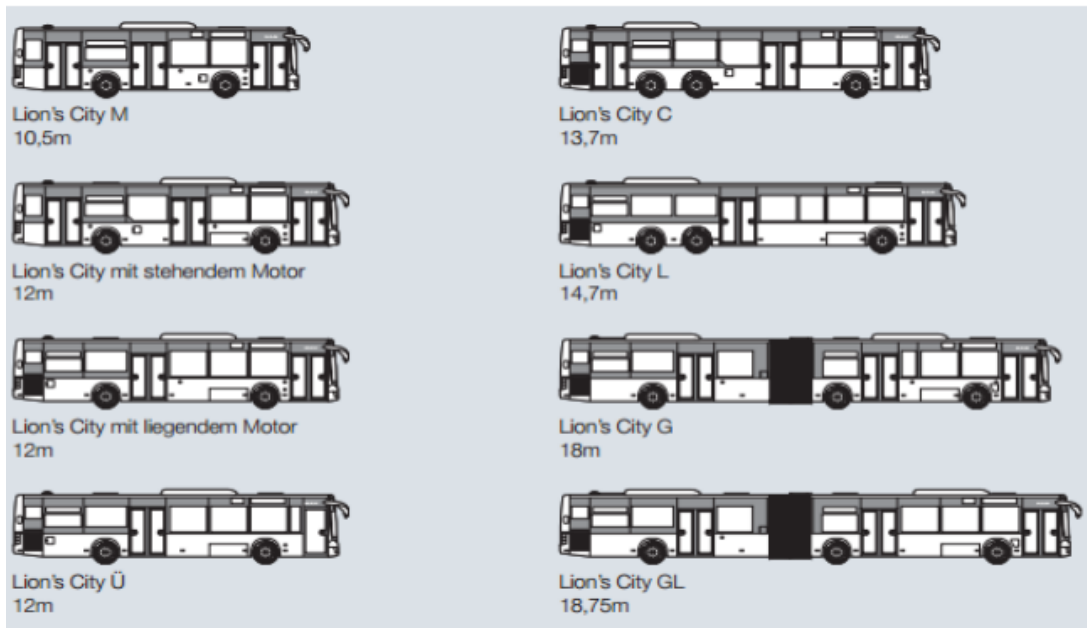
Slika 13. Različite konstrukcijske izvedbe autobusa gradskog tipa marke MAN
