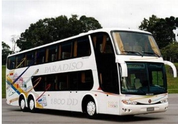
Slika 11. Primjer izvedbe katnoga troosovinskog autobusa turističke namjene
