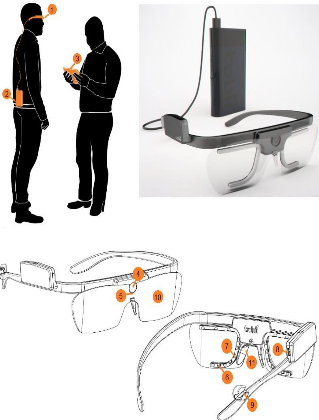
Slika 17. Komponente naočala Tobii Pro Glasses 2
