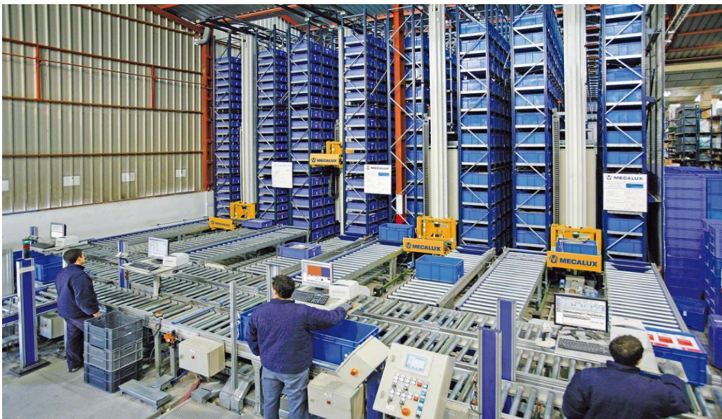
Slika 10. Prikupljanje manjih jedinica AR/RS sustavom
