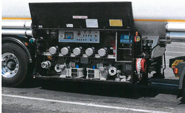
Slika 14. Senzori na vozilu za prijevoz opasnog tereta
