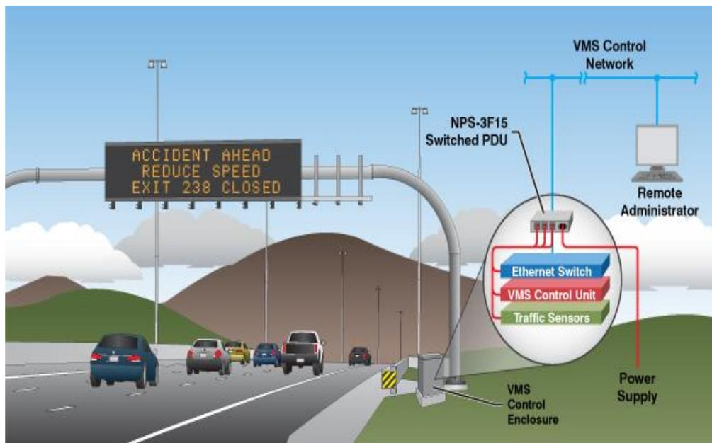
Slika 1: Dijelovi VMS sustava u okruženju ITS-a, Izvor: [7]
