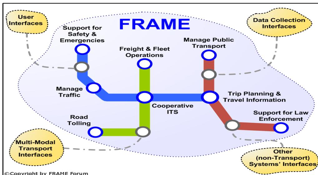
Slika 2: Podsustavi nadzornog centra za upravljanje prometom, Izvor: [10]
