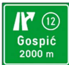
Slika 4. Znak „predputokaz za izlaz s autoceste ili brze ceste s oznakom izlaza“ (D01)
