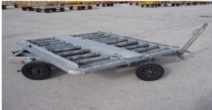
Slika 15: ULD kolica sa pokretnom platformom i sustavom valjaka
