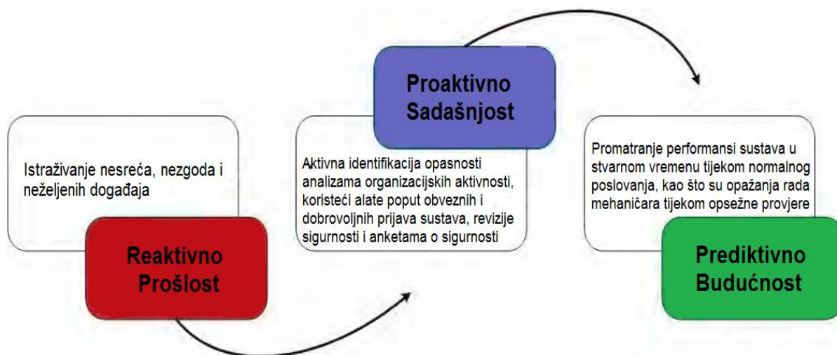
Slika 8. Prelazak sa reaktivnog na proaktivno te prediktivno djelovanje [12]
