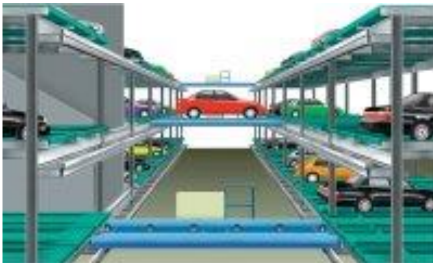
Slika 9. Multi-floor sustav za parkiranje [7]
