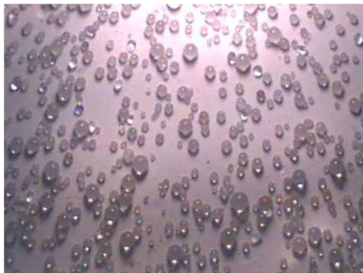
Slika 21. Prikaz nedovoljnoga utisnuća staklenih perla u materijal
