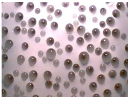
Slika 20. Prikaz optimalnoga utisnuća staklenih perla u materijal
